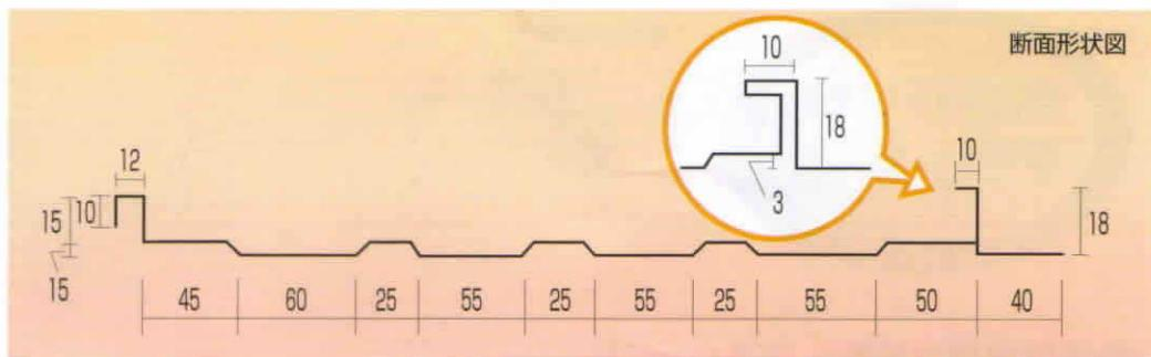
■平面部(ドブ面)に4ヶ所のリブ面を設置することにより、音鳴りやドブ面の盛り上がりを防止します。
