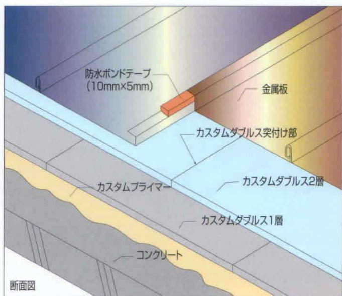
■両面粘着タイプのアスファルトルーフィングを使用した接着工法により、防水層を確保。
